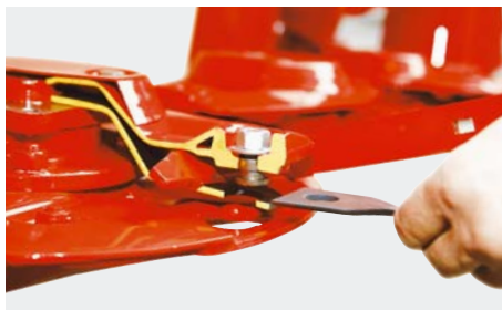
Rimozione rapida di un coltello con fissaggio FAST-FIT
