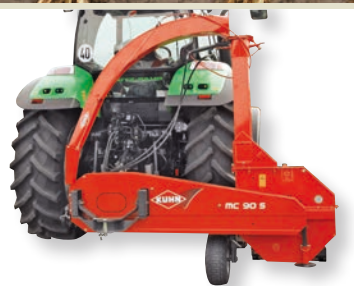
Manica ripiegabile per rimessaggio e trasporto (MC 90 S e MC 90 S TWIN)
