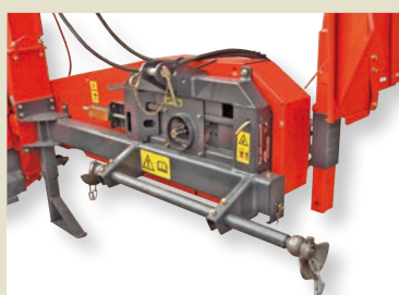
Semplice regolazione laterale per barra di traino bassa (MC 90 S e MC 90 S TWIN)
