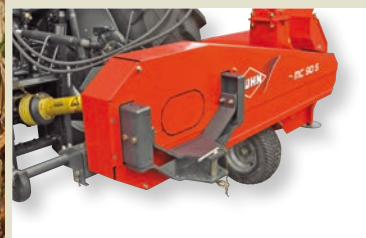
Gancio di traino in posizione bassa (MC 90 S e MC 90 S TWIN)
