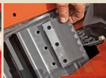
Set opzionale di pettini d'entrata per mais scivoloso o alto (di serie su MC 180 S QUATTRO)
