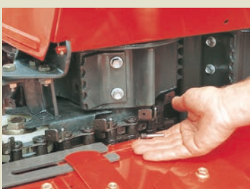
Protezione supplementare a bullone di taglio per catena d'alimentazione (MC 90 S TWIN e MC 180 S QUATTRO)
