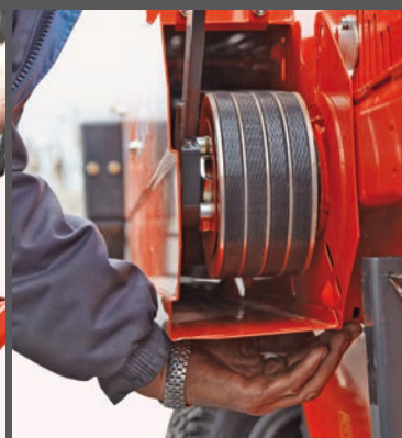
Dopo l'affilatura dei coltelli, è facile regolare la ruota trinciante
