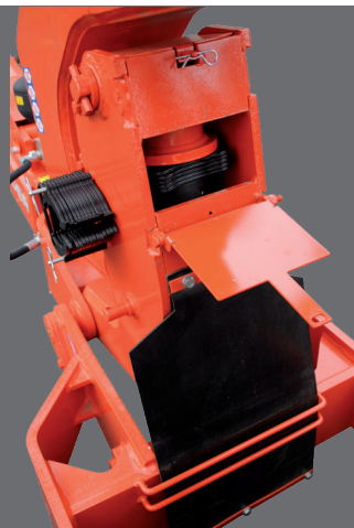
2. Profondità: mediante distanziali posizionati sul cilindro di sollevamento. Tutti gli sforzi sono assiali = nessuna sollecitazione sui perni. La regolazione della profondità si effettua tramite distanziali.
