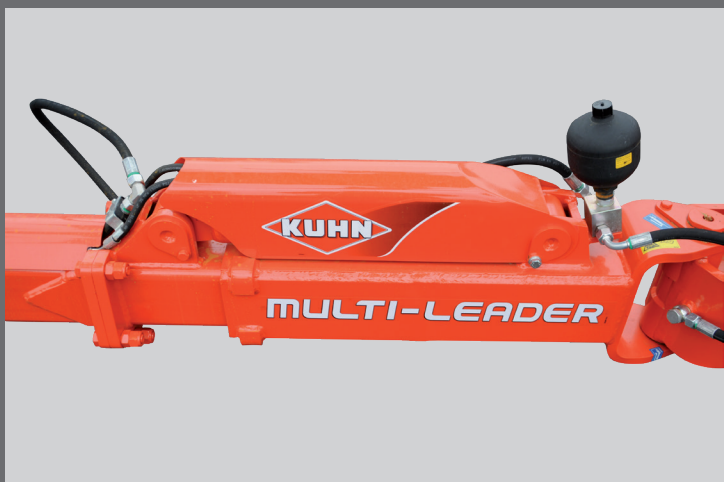
3. Disassamento: si effettua con un tirante meccanico o cilindro idraulico (opzionale), consentendo una regolazione tra pneumatici da 1,15 a 1,60 m. Un indicatore visibile dal posto di guida facilita il posizionamento, per una regolazione precisa.
