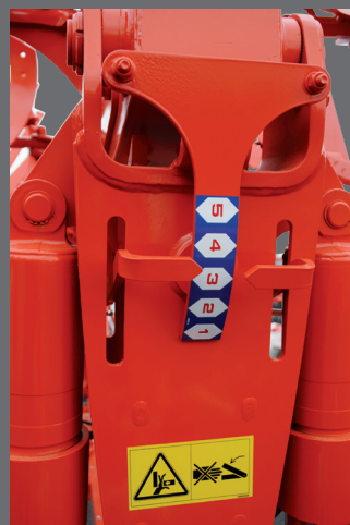
3. Disassamento: si effettua con un tirante meccanico o cilindro idraulico (opzionale), consentendo una regolazione tra pneumatici da 1,15 a 1,60 m. Un indicatore visibile dal posto di guida facilita il posizionamento, per una regolazione precisa.
