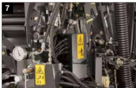
Valvola proporzionale per il controllo della densità in cabina
