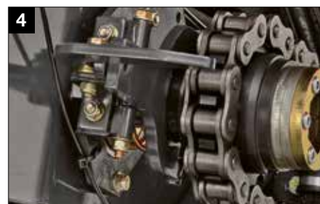
Disinnesto meccanico del rotore
