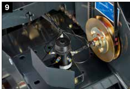
Sistema di lubrificazione in continuo delle catene BEKA-MAX
