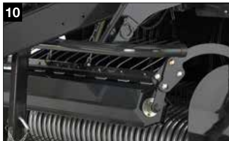
Rullo per foraggio pesante con paravento (Ø 217 mm)
