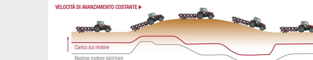
▲ L'apprezzata trasmissione a variazione continua Dyna-VT è ora dotata di una nuova modalità automatica. Consente all'operatore di usare la leva MultiPad o il pedale per variare la velocità di avanzamento, impostando automaticamente il regime del motore ottimale in base al carico e alla velocità. Oltre a garantire un funzionamento più fluido, riduce il consumo di carburante.
