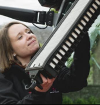
Facile accesso per la rimozione e la pulizia del filtro dell'aria della cabina.
