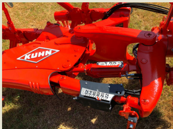
Il sistema Pro-Set semplifica l'avviamento del VARI-MASTER L modello Entro Solco
