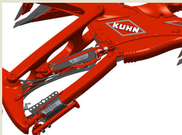
Meccanismo On Land che permette di lavorare nel solco o fuori solco
