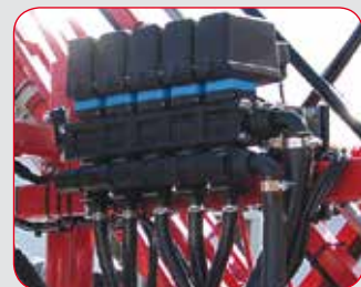
(IT) Distributori acqua elettrici
