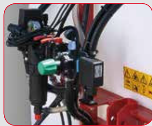
(IT) Distributore elettrico con particolare motori elettrici
