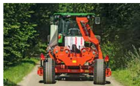
Per il trasporto su strada, le ruote possono essere ripiegate all'interno per ridurre la larghezza di trasporto. Il ripiegamento idraulico è disponibile su richiesta
