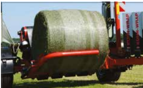
Caricamento veloce e delicato delle balle grazie al lungo braccio di caricamento
