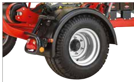
I parafranghi larghi prevengono il danneggiamento della pellicola durante il trasporto
