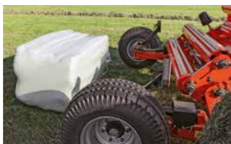
La ridotta altezza della piattaforma permette di scaricare dolcemente la palla prevenendo il danneggiamento della pellicola
