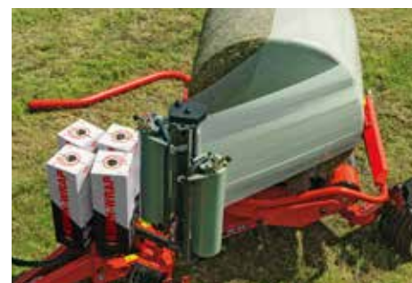
Il modello RW 1410 e RW 1610 possono entrambi essere equipaggiati con l'innovativa e unica unità di pre-tensionamento e-TWIN.
