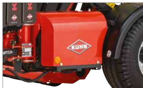
Un grande sportello laterale a protezione dell'unità idraulica assicura una facile accessibilità per gli interventi di manutenzione sulla macchina
