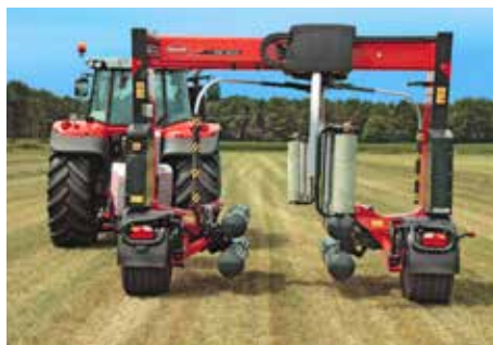
Il fasciatore si dispiega dai 2,5 m di larghezza in posizione di trasporto ai 4 m nella posizione di lavoro
