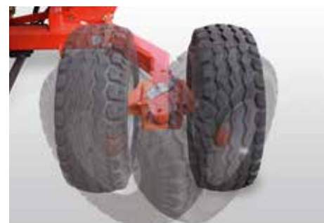
La ruota destra può essere ripiegata verso l'interno per il trasporto su strada. La ruota sinistra su richiesta
