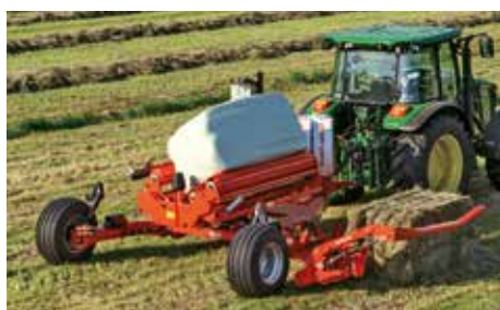
Funzione AUTOLOAD integrata sul modello SW 1614 C
