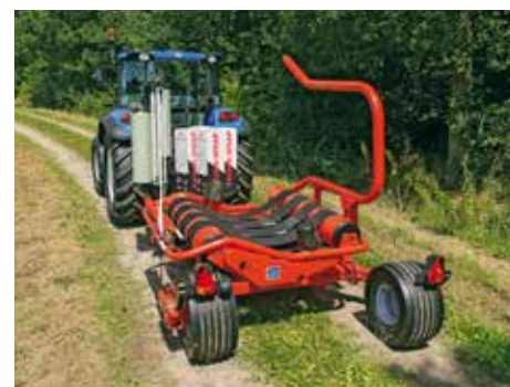
Larghezza di trasporto limitata grazie alla posizione regolabile delle ruote
