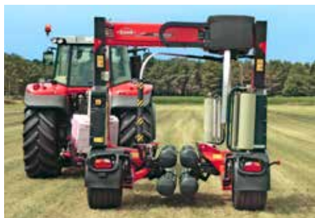
Il fasciatore si dispiega dai 2,5 m di larghezza in posizione di trasporto ai 4 m nella posizione di lavoro
