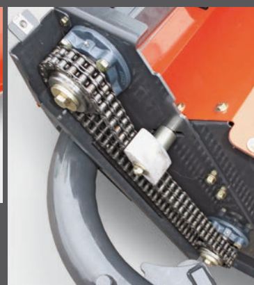
La frequenza di 815 min -1 del rotore di condizionamento può essere modificata a 650 invertendo i pignoni.
