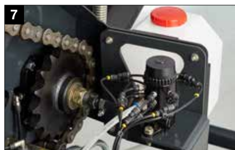
Sistema di lubrificazione catene in continuo BEKA-MAX
