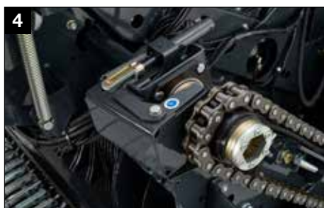
Disinnesto idraulico del rotore
