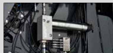
Sistema di lubrificazione automatico per i cuscinetti dei rulli
