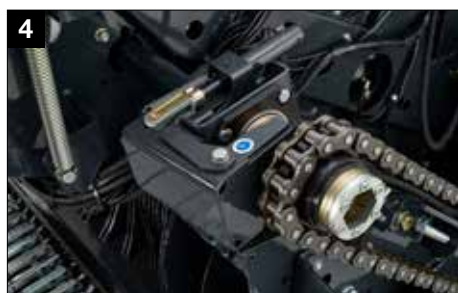
Disinnesto idraulico del rotore
