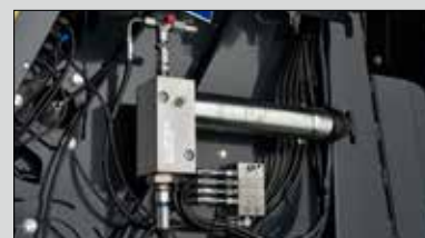
Sistema di lubrificazione automatico per i cuscinetti dei rulli
