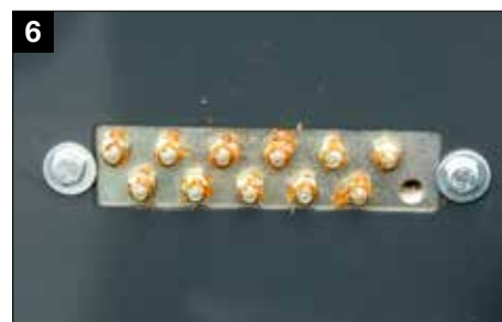
Banchi di ingrassaggio centralizzati per i cuscinetti dei rulli
