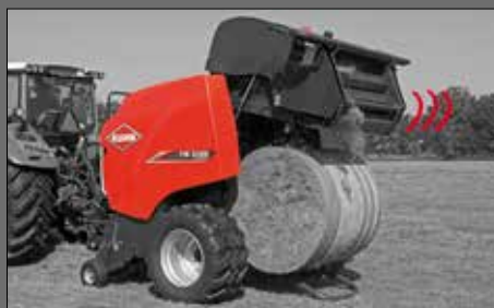
Il portellone posteriore si apre automaticamente
