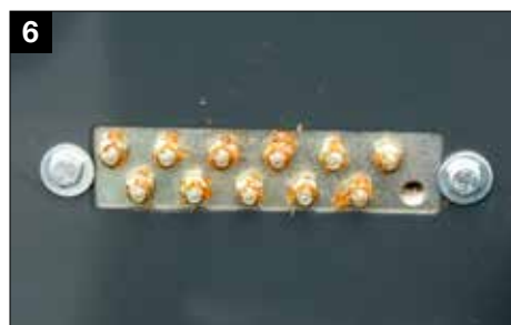
Lubrificazione automatica della catena e banchi di ingrassaggio centralizzati per i cuscinetti dei rulli
