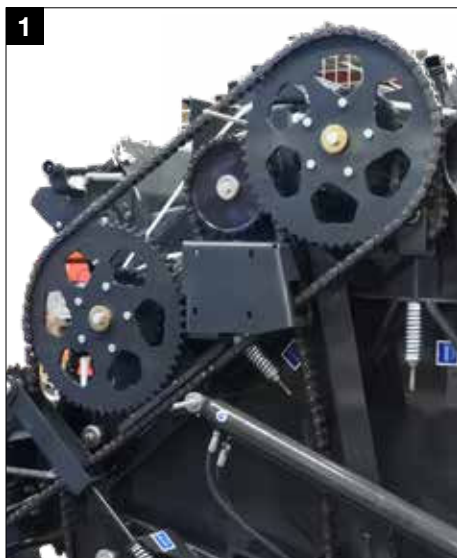
Linea di trasmissione semplice con solo 3 catene principali
