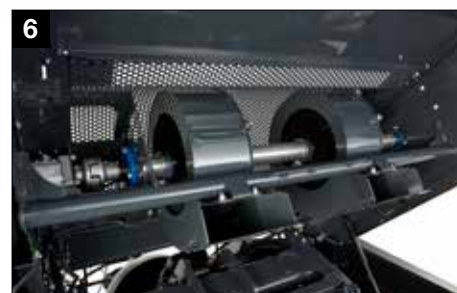
Turbine per la pulizia dell'annodatore
