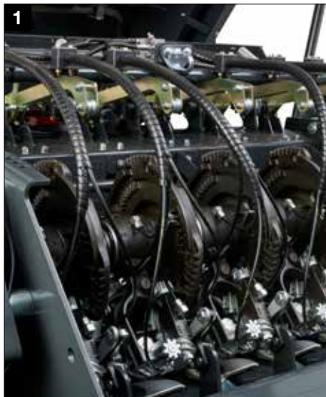
Sistema a doppio nodo con monitoraggio elettronico di serie
