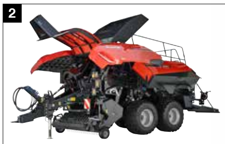
Contenitori per lo spago girevoli per una manutenzione semplice
