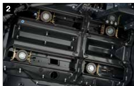
28 Rulli del pistone robusti e lubrificati
