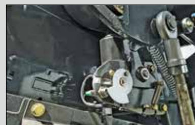
Sistema di legatura elettrico
