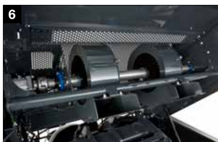
Turbine per la pulizia dell'annodatore
