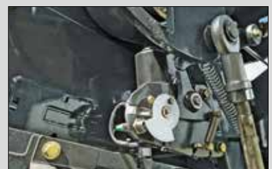
Sistema di legatura elettrico
