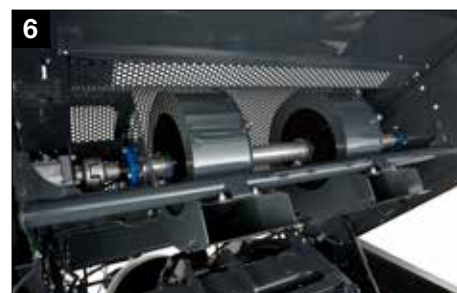
Turbine per la pulizia dell'annodatore
